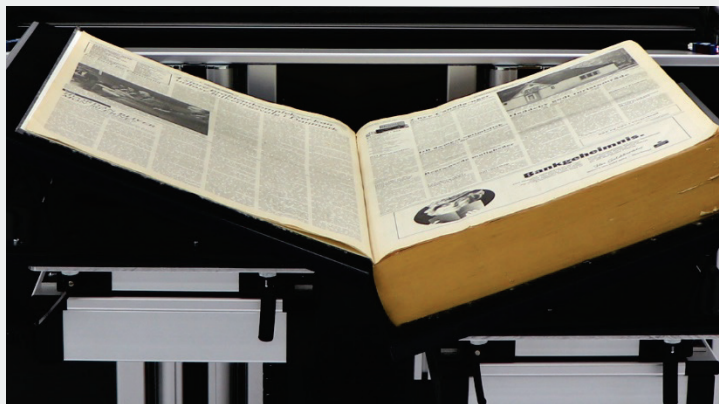
Escaneo con la base tipo V para protección de documentos y encuadernados frágiles.
