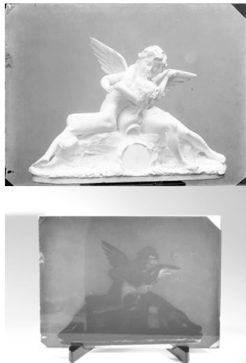
Resultados de escaneo en un WideTEK 25 con la unidad de contraluz. La imagen superior es el escaneo de la fuente. La inferior, una fotografía de alta resolución
