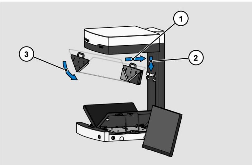
Die Glasplattenaufnahme bietet zwei Positionen für die Befestigungsschraube:
