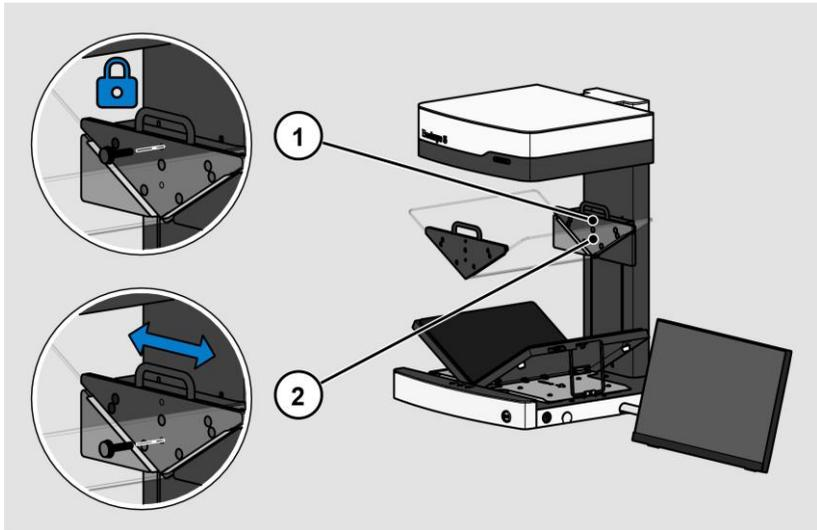
1. Wenn die Sicherungsschraube in der oberen Position (1) eingeschraubt wird, bleibt die Position der Glasplatte während des Scanvorgangs in der Horizontalen konstant. Sie ist für das Scannen von dünneren Büchern gedacht.
