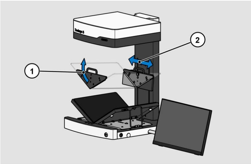
Wenn entweder die Glasplatte montiert ist oder ein Betrieb ohne Glasplatte gewünscht wird, ist die Schaltfläche INIT zur Initialisierung der Glasplatte zu betätigen. Die Funktion misst aus, ob eine V-Glasplatte installiert ist oder nicht.
