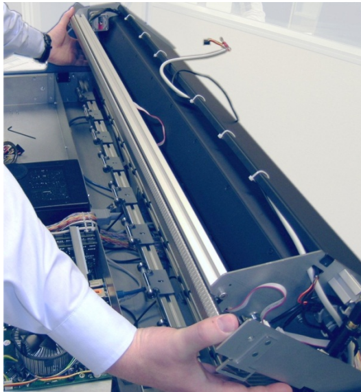
Abbildung 71: Glasplattenrahmen an den äußeren Enden halten
